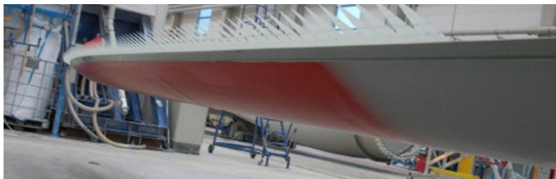
Illustrations de peignes sur les pales d'une éolienne (source : Enercon)
